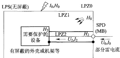
(c)采用内部线路屏蔽和在进入LPZ1处安装电涌保护器的保护
