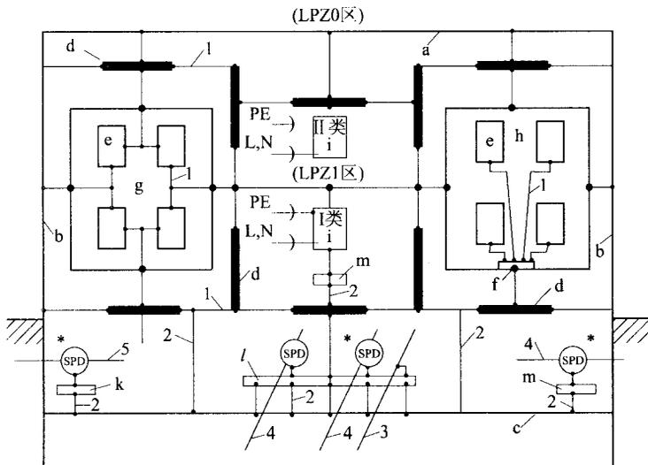
图 6.3.3 接地、等电位连接和接地系统的构成
