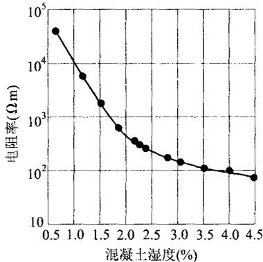
图 12 混凝土湿度对其电阻率的影响
