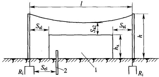
图 4.2.1 防雷装置至被保护物的间隔距离
