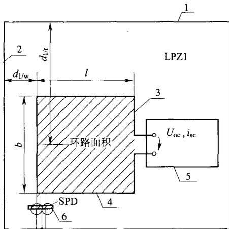
图 G.0.1 环路中的感应电压和电流
