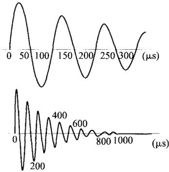
图 10 具有代表性的冲击电流波形
