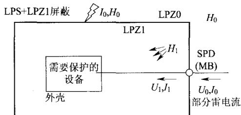
(b)采用LPZ1的大空间屏蔽和进户处安装电涌保护器的保护
