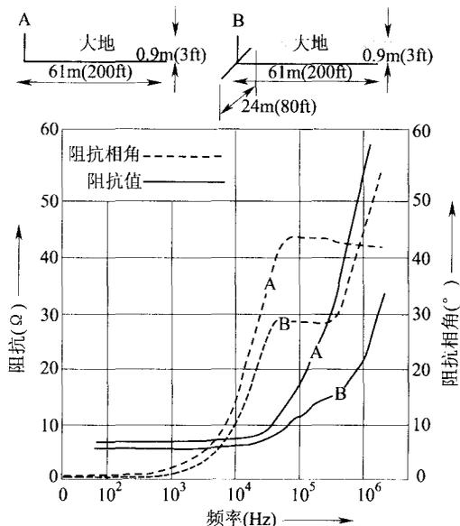
图 4 接地体的阻抗与频率的关系
