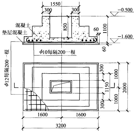
图 13 一车间的柱子基础结构图
