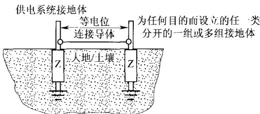
图 7 IEC 和美国 NEC 要求在各组接地体之间做等电位连接
